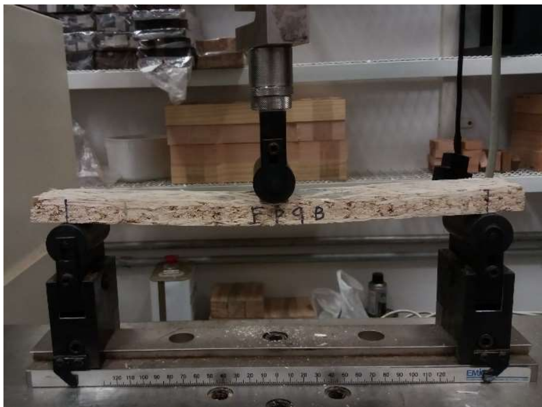
Figura 2: Ensayo de flexión estática de un espécimen de prueba de tableros OSSB.
