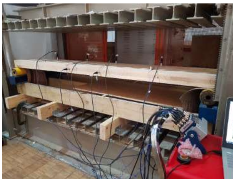
Figura 1: Instalación e instrumentación típica de los paneles para ensayos vibratorios
