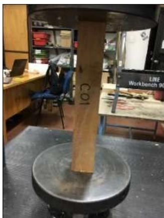
Figura 3: Montaje ensayo de compresión paralela a la fibra
