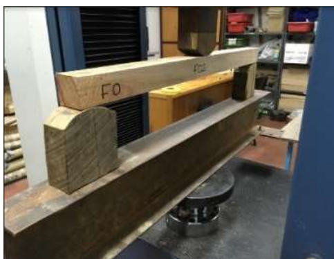
figura 4: Montaje para flexionar el elemento
