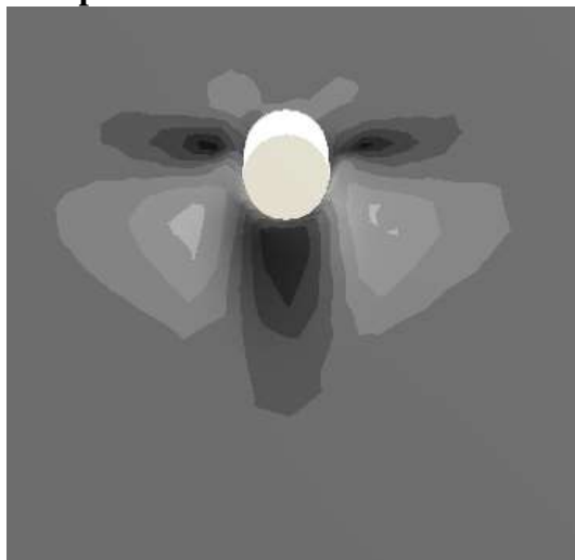
Figura 15. Caso 3. Componentes de la tensión en los tres ejes principales y tensión de corte en el plano XY.
