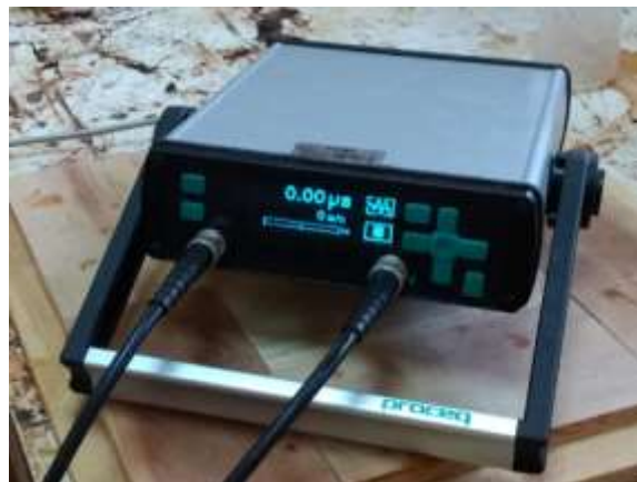
Figura 1 – Aparelho de ultrassom utilizado no ensaio não destrutivo.
