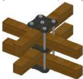
Figura 7: Ligação com encaixe na parte externa Fonte: Carvalho, 2015
