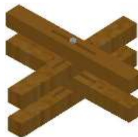
Figura 8: Ligação com parafusos internos Fonte: Carcalho, 2015
