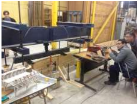
Figura 10: Viga principal – armado y ensayo de flexión.
